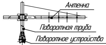
15. Поднимаем мачту на высоту 1,0 -1,5 м и устанавливаем поворотное устройство с антенной на верхней площадке мачты с помощью болтов (входят в комплект поставки поворотного устройства)
